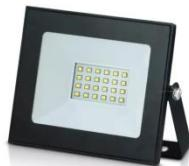
25. Renglón N° 25 - REFLECTOR LED EXTERIOR 20W CON SENSOR DE MOVIMIENTO- LUZ BLANCA FRIA: El material deberá cumplir con las Normas IRAM, Potencia: 20w, Tensión: AC220-240V, Angulo de apertura: 110°, Clasificación IP: IP66, Lúmenes: 2160lm, Aprueba de agua, Encendido instantáneo, Material del cuerpo: aluminio, Luz fría 6500 k. Deberá ser de primera marca.
