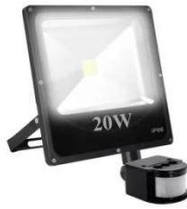
26. Renglón N° 26 - REFLECTOR LED EXTERIOR 20W - CON SENSOR DE MOVIMIENTO Y FOTOCELULA - LUZ BLANCA FRIA: El material deberá cumplir con las Normas IRAM, Potencia: 20w, Tensión: AC220-240V, Angulo de apertura: 110°, Clasificación IP: IP66, Lúmenes: 2160lm, Aprueba de agua, Encendido instantáneo, Material del cuerpo: aluminio, Luz fría 6500 k. Deberá ser de primera marca.
